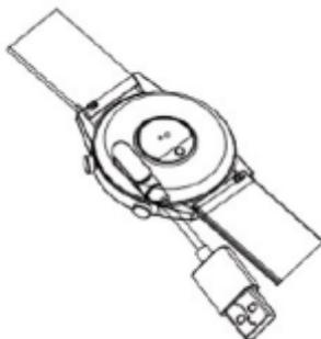
Carregue o smartwatch de acordo com a imagem. É necessário o carregamento a 100% para ativar o smartwatch quando for iniciado pela primeira vez. Aviso: Não utilize um carregador com potência superior a 5V 2A para carregar.
